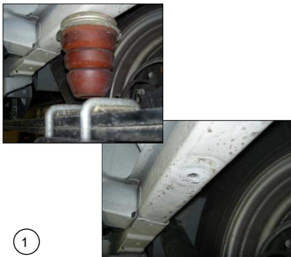
**NL** Verwijder beide aanslagrubbers van het chassis.
