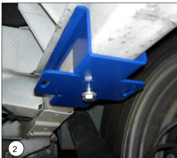
**NL** Plaats nu de bovenplaat, zodat deze strak om de chassisbalk past en zet deze vast met de M10 veerring en M10x30x1,25 bout.
